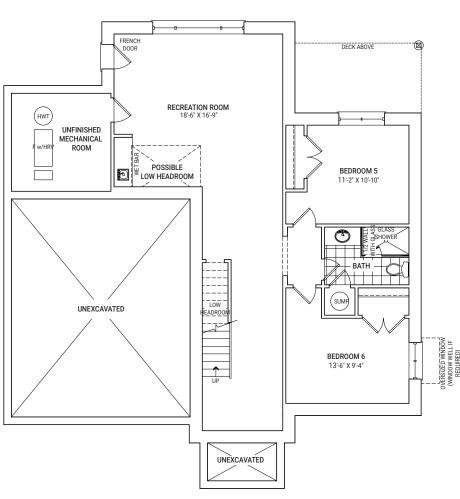
OPT. FINISHED BASEMENT PLAN ELEVATION D
